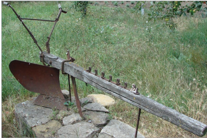
Однокорпусний плуг (з експозиції музею Фрумушика-Нова) Plug cu un singur corp (din expunerea muzeul Frumushika-Nova) Single-hull plow (from the exposition of Frumushika-Nova museum)
